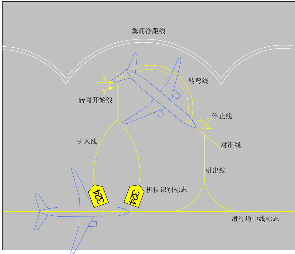
图35 飞机斜置式机位标志示意图
